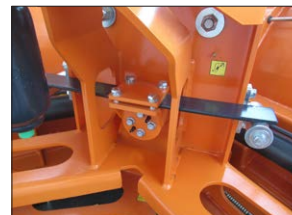
Pendelachse mit Blatt-Rückholfeder
