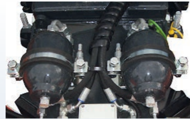
Ein- oder Zweihydraulikspeicher je nach Steuergerät am Fahrzeug
