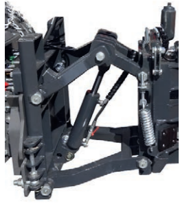
Getrennte Hebe- und Schwenkeinrichtung
