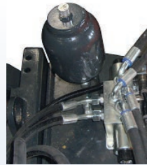
Ein- oder Zweihydraulikspeicher je nach Steuergerät am Fahrzeug
